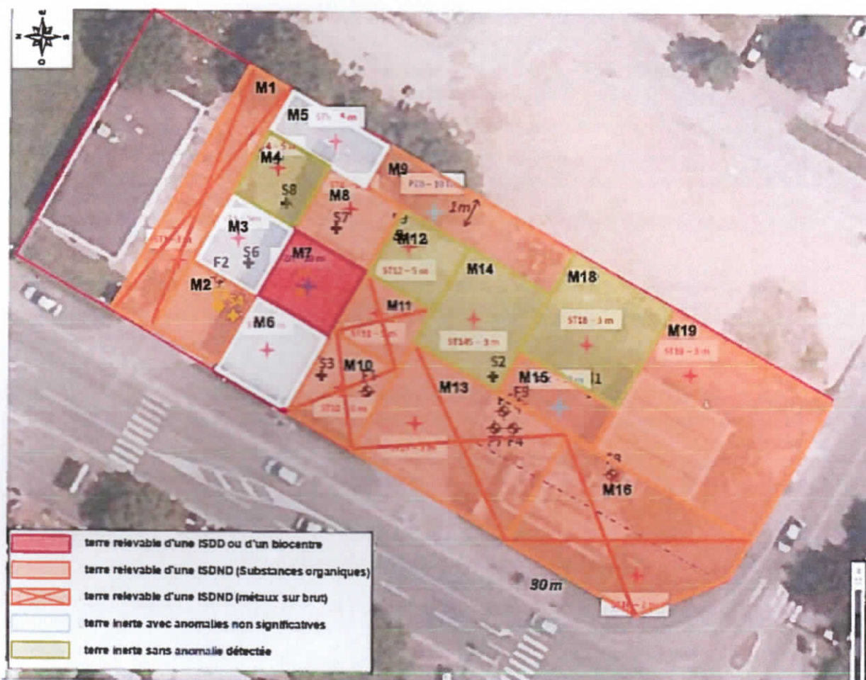
Figure 6 : Plan de maillage et orientation des terres (extrait du rapport APAVE du 13/01/2017)
