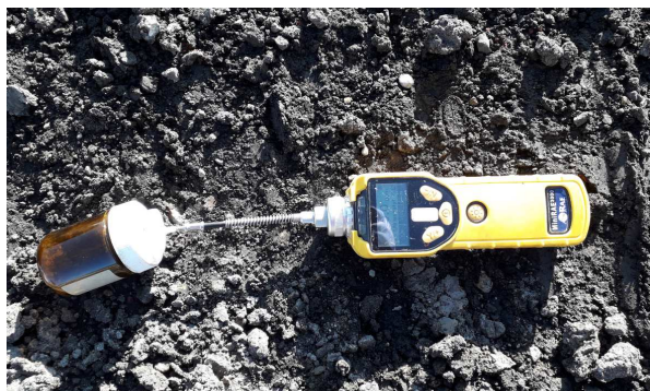
PID = 0 ppm – Remblais à – 1 m secteur 1
