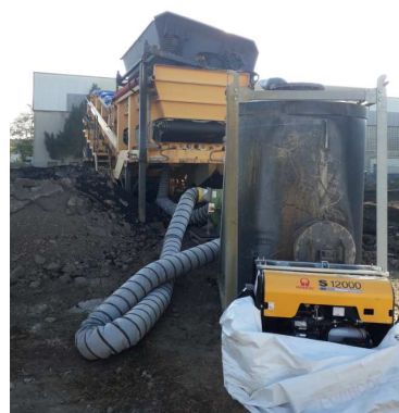
Traitement sur charbon actif des volatils aspirés
