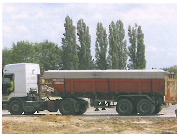
19/06/08 : Camion bâché utilisé pour le transport des terres à destination du biocentre
